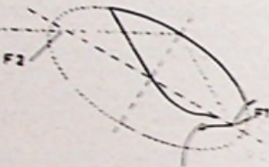
Fig. 2. HET PRINCIP VAN DE „CONQUE“. Het door de in brandpunt F1 geplaatste luidspreker uitgestraalde geluid wordt in het andere brandpunt — F2 — gebundeld.
